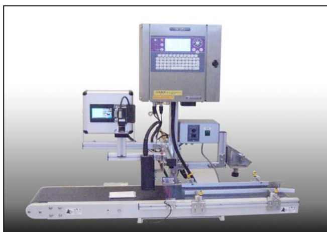
イマージュのインクジェットプリンター 「image9030」(右)と オプテックス・エフエーの文字認識 画像センサ「MVS-OCR-MI」(左)
